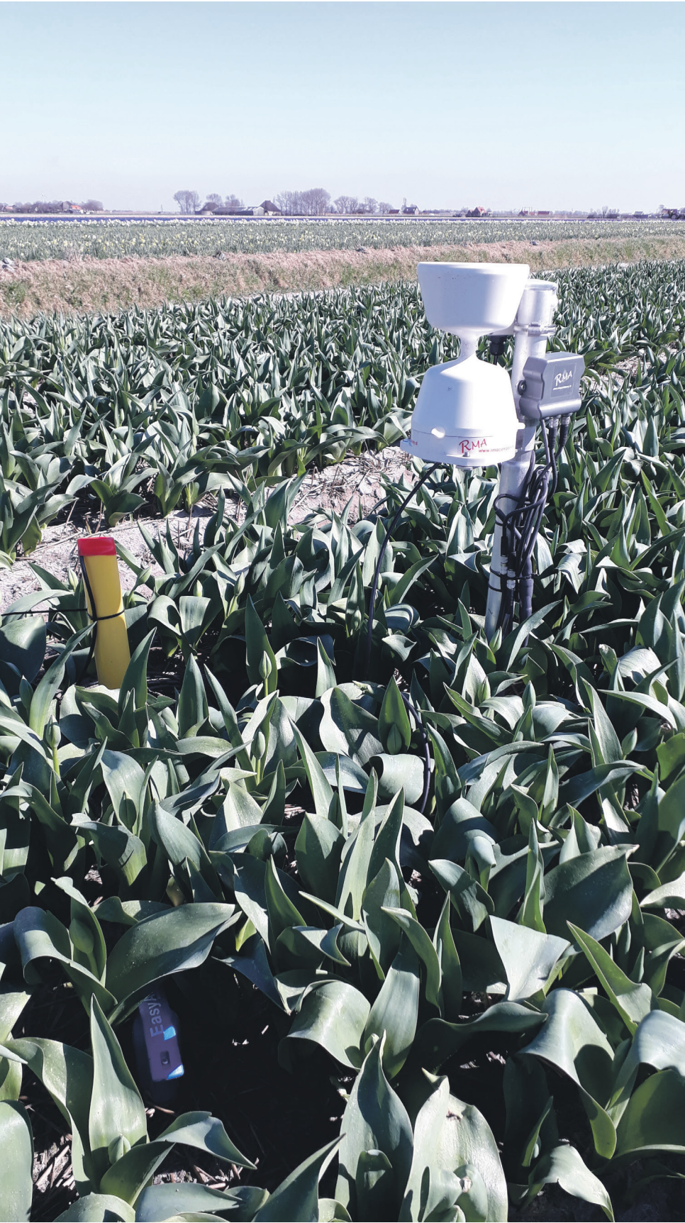
Raatjes: Zodra er bij bijvoorbeeld druppelirrigatie meststoffen meegegeven worden, tonen die sensoren direct een stijging van die stoffen.
