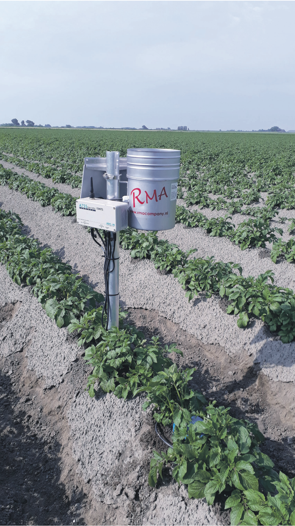
Raatjes: Zodra er bij bijvoorbeeld druppelirrigatie meststoffen meegegeven worden, tonen die sensoren direct een stijging van die stoffen.
