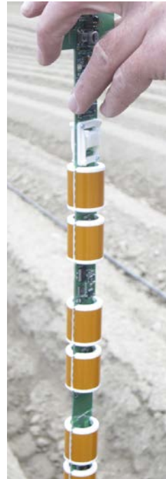
Der SM-1 Sensor sitzt in einem Plastikrohr und misst den volumetrischen Wassergehalt.
