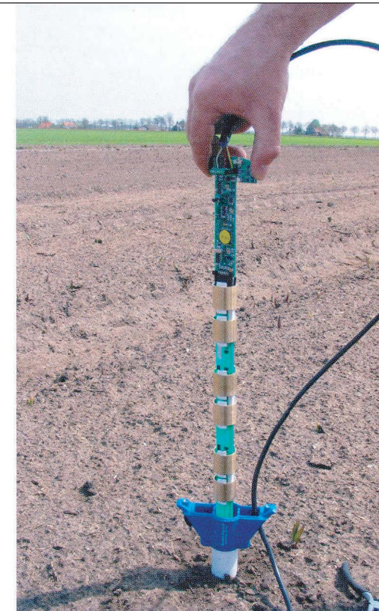
In een plastic buis wordt de EasyAG bodemvochtsensor geplaatst. De resultaten zijn op de computer uit te lezen
